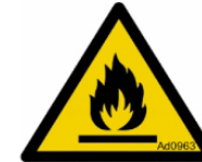
Figure 65 : danger de substances inflammables.
